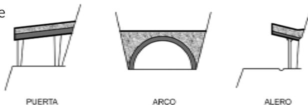
**Sistemas típicos para el control del material caído o deslizado**
