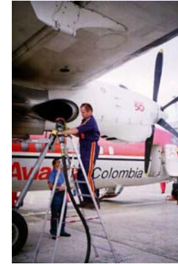
FOTO 6.6. APROVISIONAMIENTO DE COMBUSTIBLE
